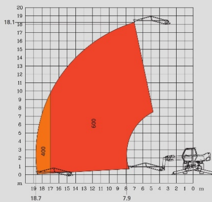
ROTAZIONE SU STABILIZZATORI COMPLETAMENTE SFILATI CON BRACCETTO P 600
